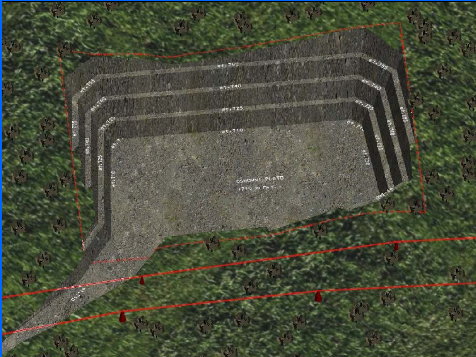
Slika 8.2.43 Trodimenzionalan model tehnički uređenih završnih kontura površinskog kopa
